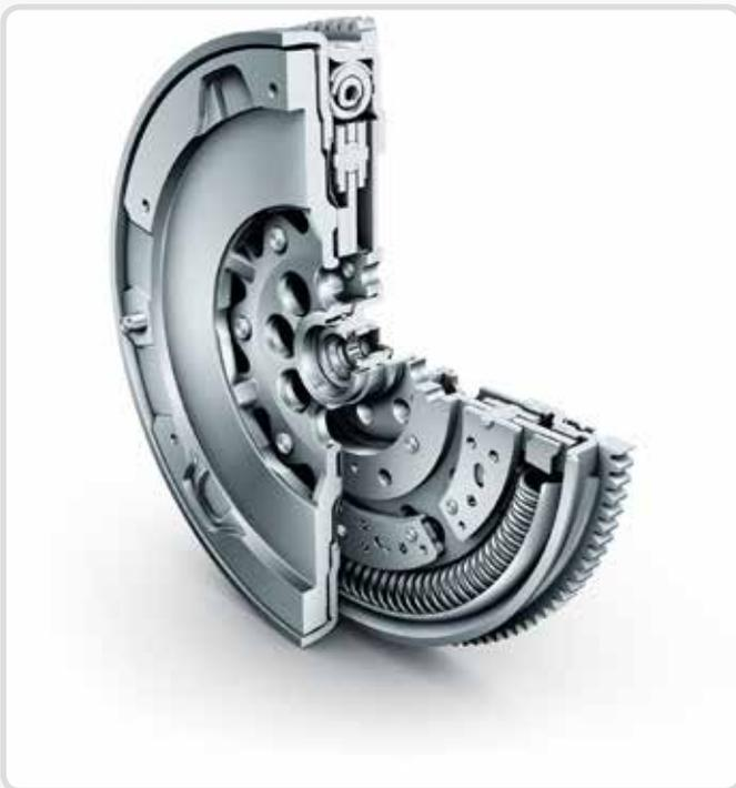
현재의 내연기관 엔진은 보모다 강력한 파워와 토크를 생산하면서 경량화를 추구하고 있습니다. 이들은 또한 보다 적은 연료소모와 배기 가스 배출을 요구하면서 부드럽고 안락한 주행감을 제공하도록 요구 받고 있습니다. 소음수준과 변속의 안락감에 대한 요구 증대로 인하여 종전의 토션 스프링을 장착한 클러치는 더 이상 보다 강해진 엔진의 진동을 흡수하기에는 부적절하게 되었습니다. DMF는 오늘날 최신의 자동차를 구매하는 고객에게 이러한 요구 사항들을 만족 시키기 위해서 개발된 장치중의 하나입니다. 엔진토크는 primary mass의 아크스프링과 플랜지를 통하여 secondary mass로 전이되는데 primary와 secondary mass 사이의 베어링에 의해서 질량의 독립적인 경방향 이동이 가능합니다.
